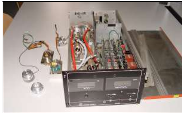
Resim 2.2: Karbon oksitlerin ölçümünde kullanılan araçlardan Nondispersive InfraRed Spektroftometre
