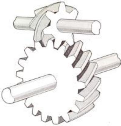
Şekil 1.3: Mil eksenleri ayrı düzlemlerde olan helisel dişli çarklar
