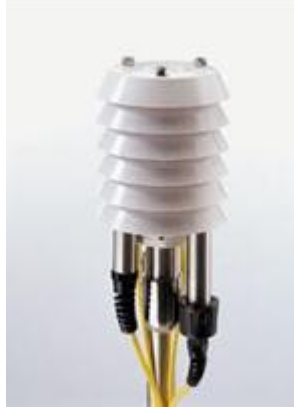
Resim 1.2: Siper içerisinde hava sıcaklığı ölçer
