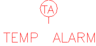
Şekil 1.9: Sıcaklık alarmı göstergesi
