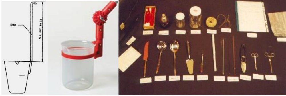
Sıvılar için uygun keçe (kapasitesi en az 50 ml ve sap kısmı en az 500 mm.)
