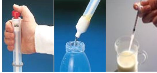
Resim 2.1: Sıvılardan numune alınması
