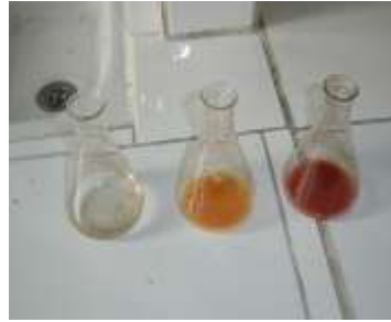
Resim 2.14: Titrasyon başlangıcı, sonu ve aşıldığında oluşan renkler.
