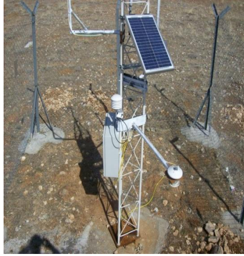
Resim 1.1: Coğrafi alana kurulmuş güneş ölçüm istasyonları
