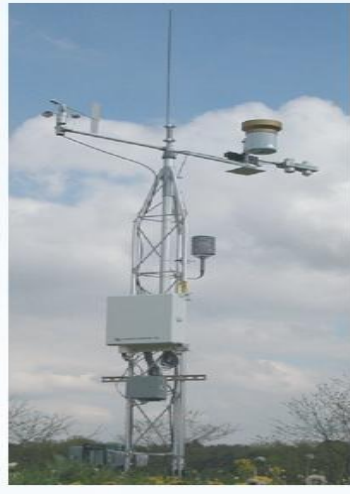
Resim 1.1: Coğrafi alana kurulmuş güneş ölçüm istasyonları
