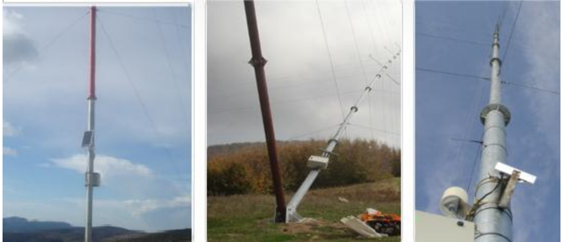
Resim 1.2: Boru tipi ölçüm direği
