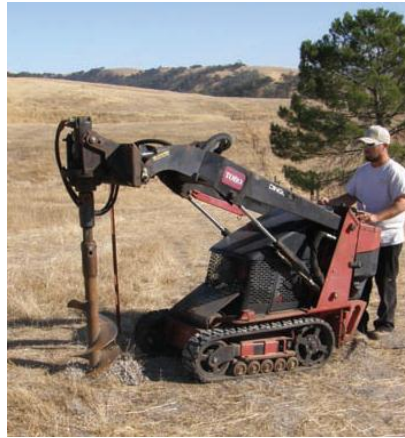
Resim 1.4: Temel çukuru açmak için kullanılan makine
