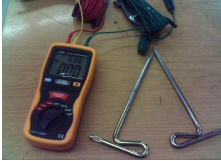
Resim 5.1: Dijital topraklama direnç ölçüm meger cihazı
