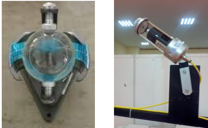
Resim 1.2: Güneşlenme süresi ölçer (heliyograf)
