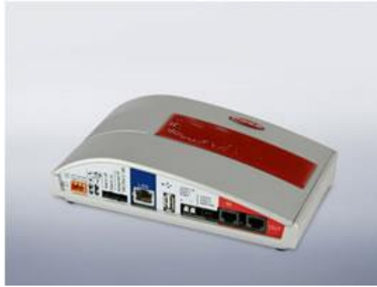
Resim 3.1: Test verileri toplama ve kaydetme ünitesi (datalogger)
