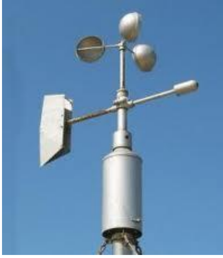
Resim 1.3: Rüzgar hız ölçer (anemometre)
