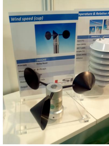
Resim 1.3: Rüzgar hız ölçer (anemometre)
