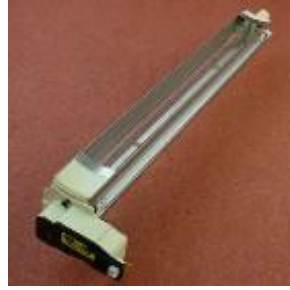
drum ünitesi ve ana şarj korona kurulumu
