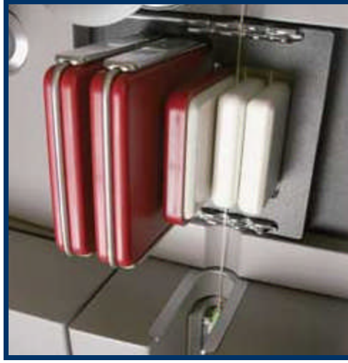
1.3: Düzgünsüzlük kontrolü (kondansatör)
