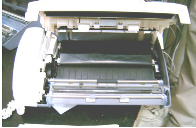
Resim 1.1: Karbon şeritli faksta bulunan karbon şerit ve yuvası
