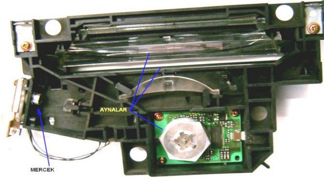
Resim 1.3: Lazer faksın içindeki ayna ve mercekler
