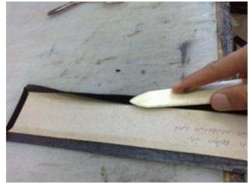
Resim2.31:İç kolon kenar kıvrırma
