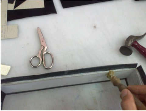
Resim2.30:Kolona yapıştırıcı sürme
