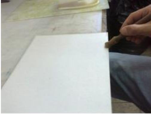
Resim2.1:Kapak mukavvasına yapıştırıcı sürme
