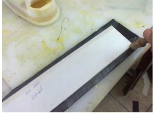
Resim 2.16: Kolona Kıvrımlık Sürme
