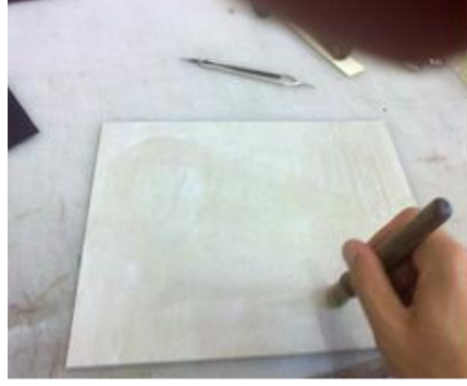
Resim2.6:Kapak altı mukavvasına yapıştırıcı sürme
