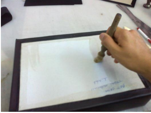
Resim 2.28: Alt Taban Yapıştırma
