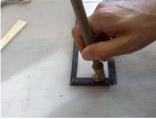
Resim 2.18: Kısa Kenar Yapıştırıcı Sürme
