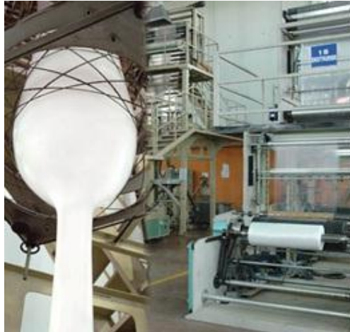
Resim 1.3: Alçak yoğunluk polietilen üretimi
