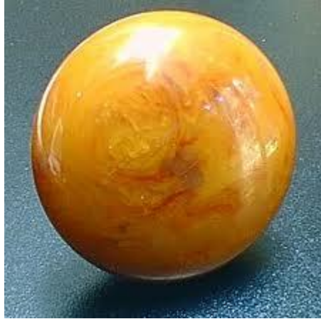
Resim2.2: Fenolün formaldehitte birleşmesiyle oluşan doğal bakalit
