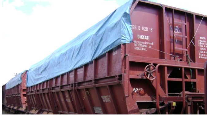
Resim 1.11: Eşyaların muşamba ile korunması
