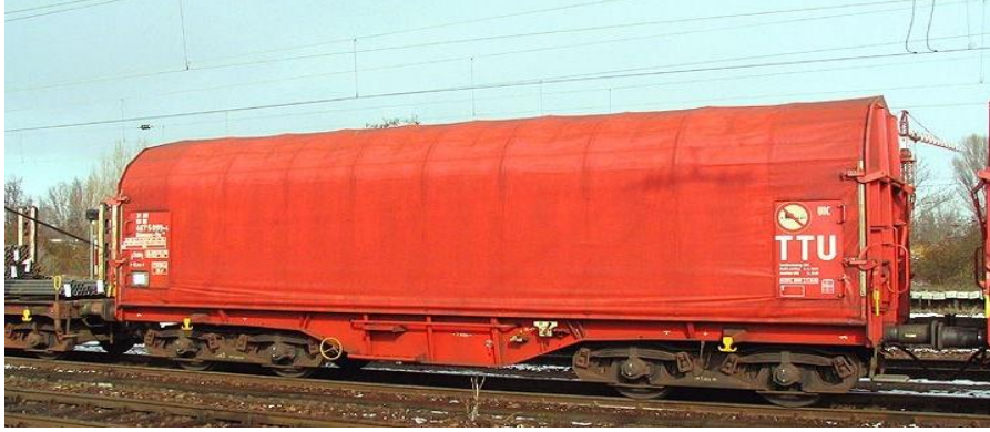
Resim 1.12: Patlayıcı madde yüklü vagonlarda muşamba kullanımı
