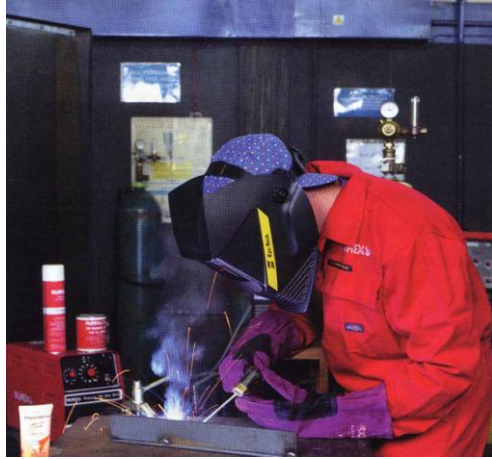
Resim 1.2: Güvenlik kurallarına uyularak yapılan elektrotla kesme
