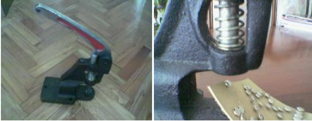
Fotoğraf 1.10: Fermajup aleti Fotoğraf 1.11: Fermajup aleti ile zimba basma
