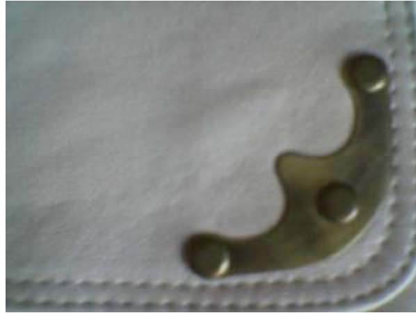
Fotoğraf 4.2: Kapalı zımba ile birleştirme
