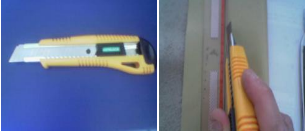
Fotoğraf 1.7: Maket bıçağı Fotoğraf 1.8: Maket bıçağı ile kesim yapma
