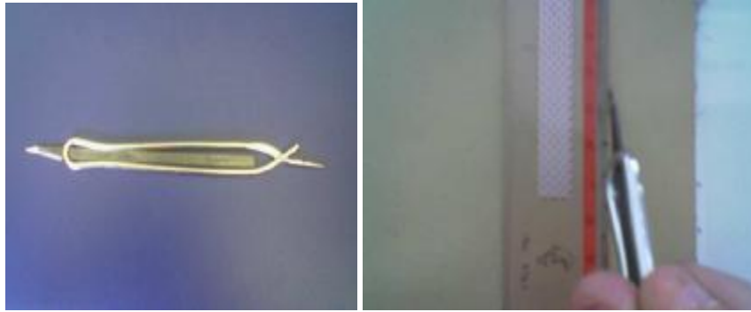
Fotoğraf 1.5.: Deri kesim bıçağı Fotoğraf 1.6.: Deri kesim bıçağı ile kesim yapma
