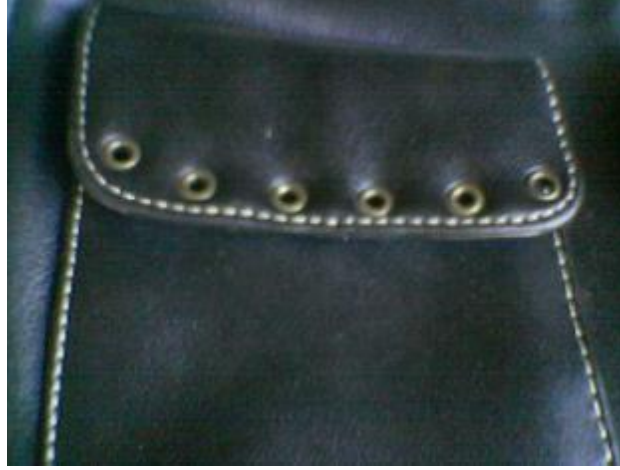
Fotoğraf 4.1: Açık zımba ile birleştirme
