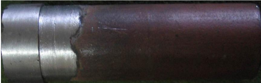
Resim 2.4: Dolgu kaynağı ile dolgusu yapıp işlenmiş mil
