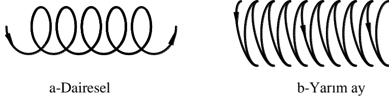
Şekil 2.12: Dolgu kaynağı elektrot hareketleri
