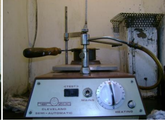
Resim 5.6: Alevlenme noktasının tespiti
