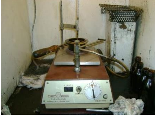
Resim 5.5: Cihaz üzerine konmuş test kabı
