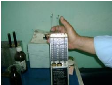
Resim 5.2: Viskozitemetrenin sıfır ayarı
