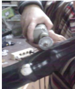
Resim 2.2: Çizilen yerlerden kesilmesi
