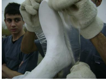
Resim 1.10: Termoplastiđin derin ekimi
