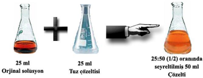
Şekil 1.1: Orijinal solüsyonun seyreltilmesi
