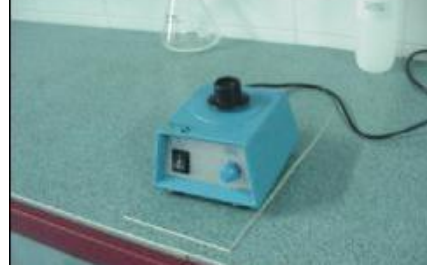
Resim 2.2: Tüp karıştırıcısı (vortex)
