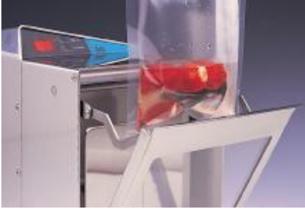
Resim 2.5: İçinde numune ve dilüsyon sıvısı bulunan torbanın yerleştirilmesi
