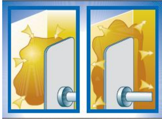
Şekil 2.1: Stomacher’ın pedal hareketi
