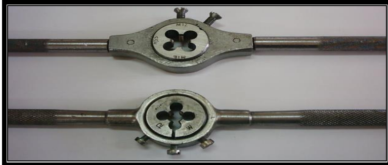
Resim 2.5: Paftanın, pafta koluna takılması
