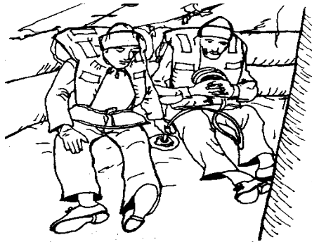
Şekil 7.4: Can salının tabanının şişirilmesi
