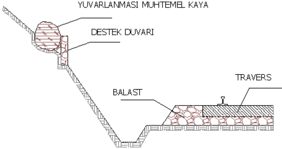
Şekil 2.7: Düşme ihtimali olan taşın önüne çimento harçlı destek duvarı yapılması
