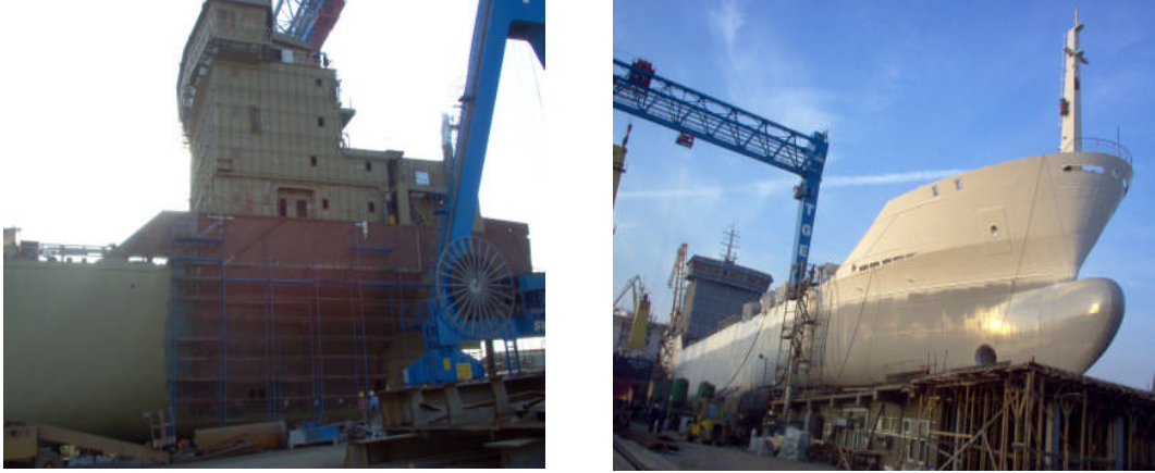
Resim 2.1: Gemi astar boyasının yapılışı
