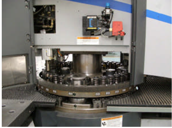
Resim 1.2: Taret tipi magazin ve şematik görünüşü
