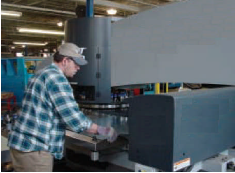
Resim 2.2.: Sac plakasının tezgaha yüklenmesi
