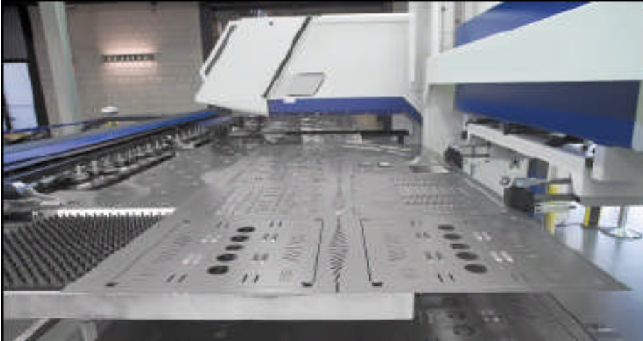
Resim 1.1: CNC punc makinesinin çalışma esnasındaki görünümü
