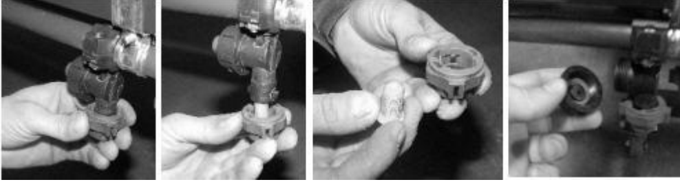
Resim 1.3: Memelerin kontrolü ve temizlenmesi
