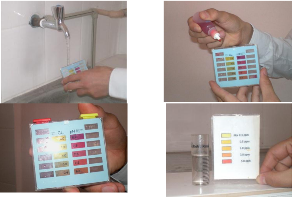
Resim 2.6: Klor test kitleri ile serbest klor ölçümü
