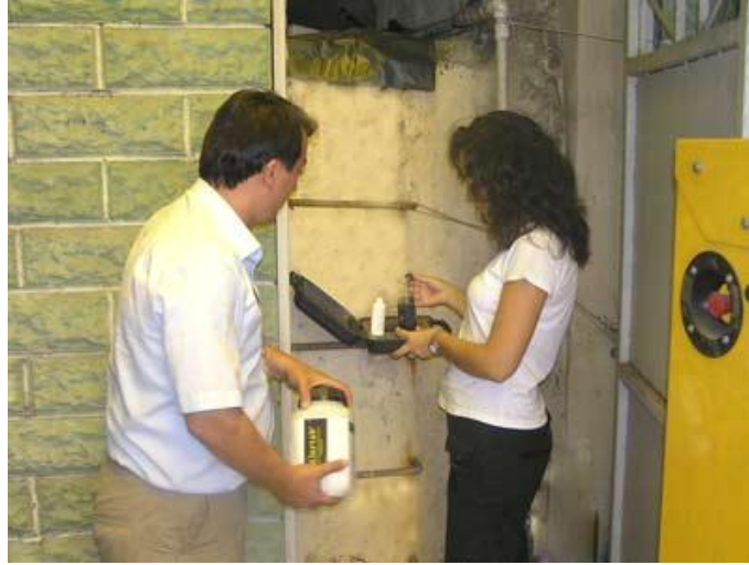
Resim 2.2: Serbest klor ölçümünün yapılması
