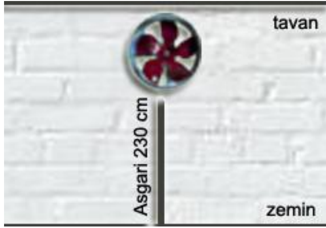
Resim1.6: Aspiratörün duvar montajının gösterilmesi
