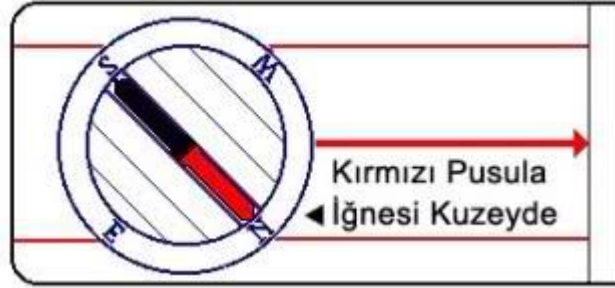
Şekil 2.3: Pusula iğnesinin kuzeyi ile pusula yuvasının içindeki kuzeyi karşılaştırana kadar dönüş yapma
