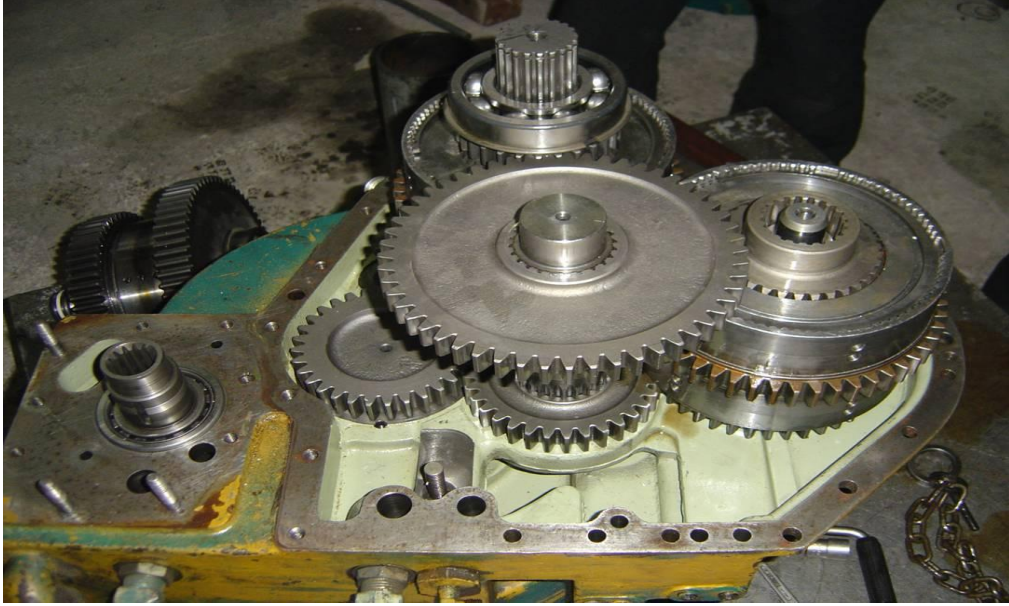
Resim 1.4: Kavrama dişlilerinin görünümü
