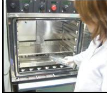
Resim 1.5: Etüv su cebine su eklenmesi
