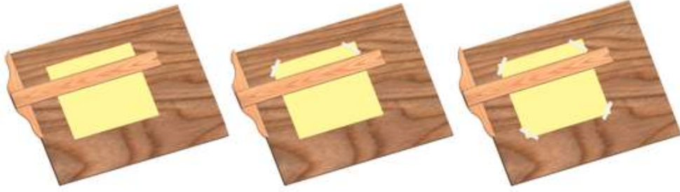
Resim 1.1: “T” cetveli yardımıyla resim kâğıdının çizim masasına tespiti
