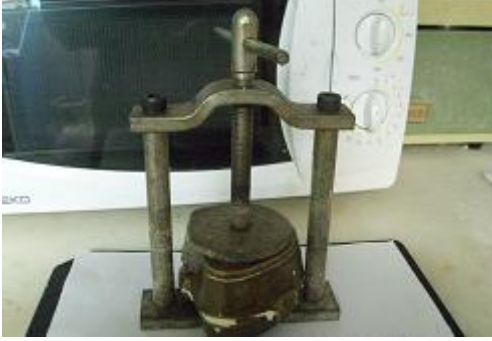
Resim 2.12: Biritle muflanın sıkıştırılması
