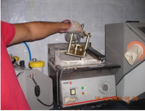
Resim 2.13: Muflanın kaynatma cihazına yerleştirilmesi
