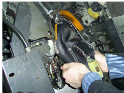
Resim 1.11: Sayanın ön montajıneopren sürülmesi
