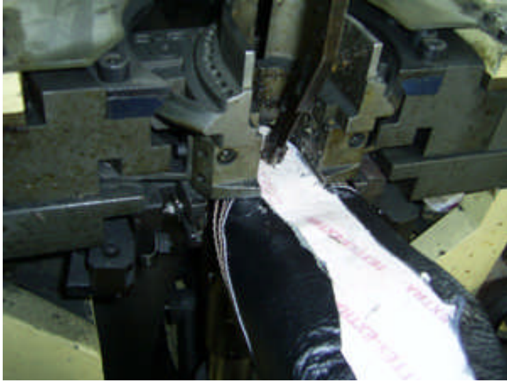
Resim 2. 1: İş ve güvenlik ayakkabısının arka montajı
