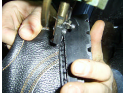
Resim 2. 3: Mekval dikişinin yapılıması
