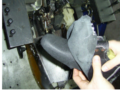
Resim 1.8: Astarın ön montajı
