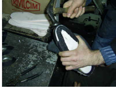
Resim 1.9: Çelik bombenin kalıba çakılması
