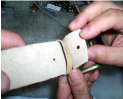
Fotoğraf 2.31 :Tokalığa köprü yerleştirme
