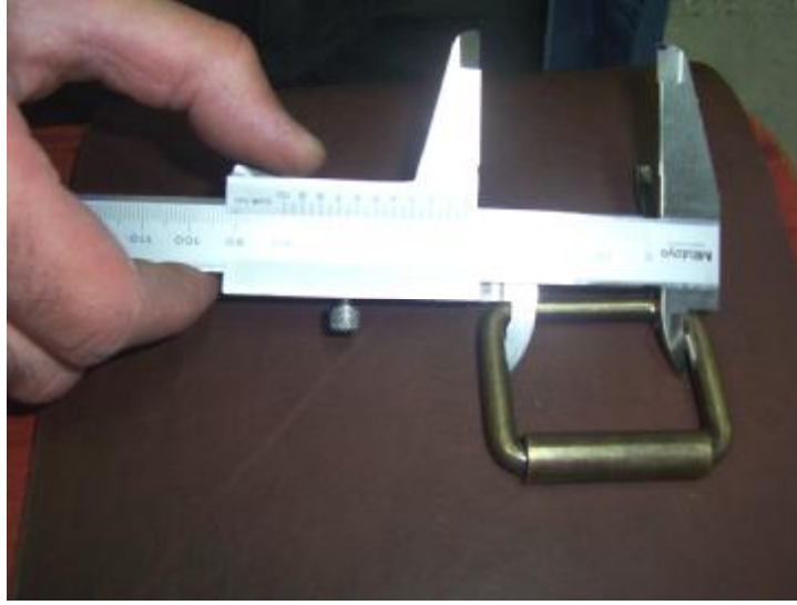
Fotoğraf 2.15: Kumpasla toka iç ölçümü
