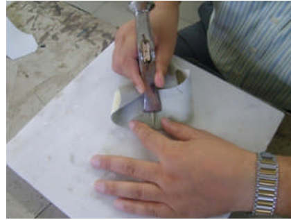
Foto. 2. 4: Yüzün çatılan yerine açma yapılması
