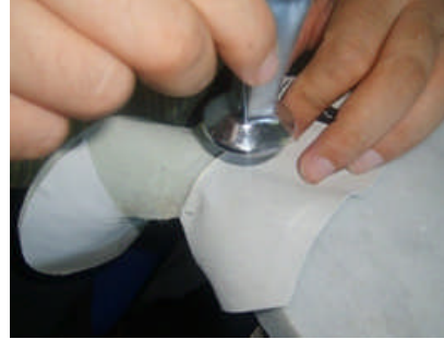
Fotoğraf 3. 8: Dikiş yerlerine açma yapılması
