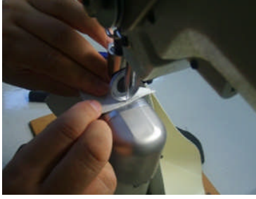
Fotoğraf 2. 5: Gamba astarlarının çatılması
