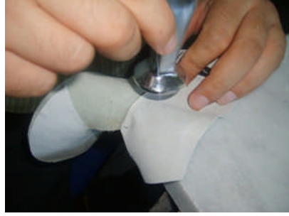
Fotoğraf 3. 21: Dikiş yerlerine açma yapılması
