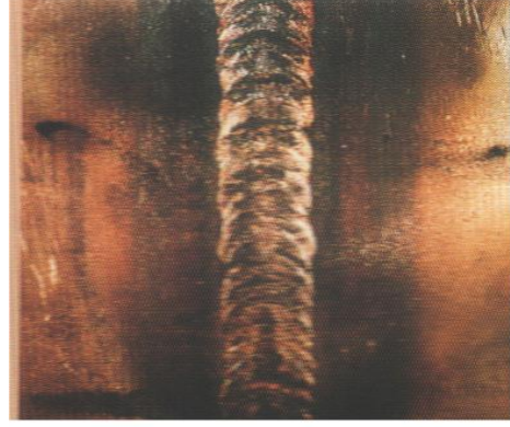
b. Bakır kaynağı yapılmış birleştirme
