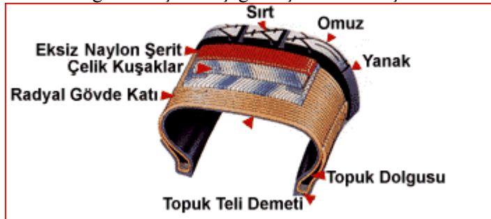
Resim 1.5: Lastik içerisinde bulunan yapılar
