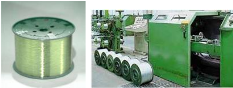
Resim 1.2: Üretilen çelik kordların makaralanmış hâli
