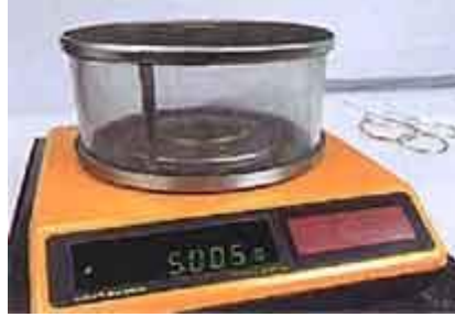
Resim 1.6: 1 metresi hassas terazide tartılan çelik kord
