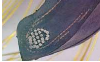
Resim 5.2: Topukta bulunan çelik kordlar
