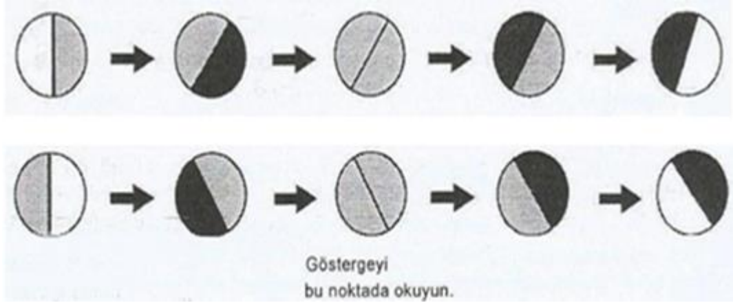
Şekil 3.4: Dijital polarimetrede ölçüm görüntüleri
