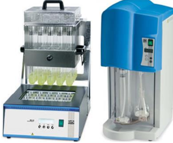
Resim 1.2: Kjeldahl cihazı yakma ünitesi ve damıtma ünitesi
