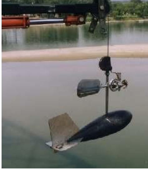
Fotoğraf 2.1: Akıntıölçer (Current Meter)
