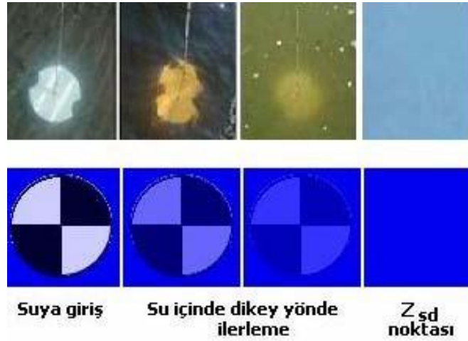
Fotoğraf 1.3: Seki diskin su içinde ilerlemesi ve Z_{sd} noktasına ulaşması
