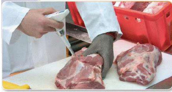
Resim 1.1: Kırmızı ette portatif pH metre ile pH ölçümü
