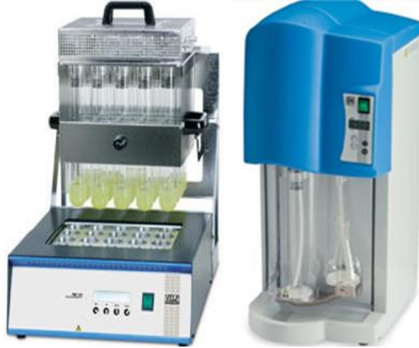
Resim 5.1: Mikro kjeldahl cihazı yakma ünitesi ve damıtma ünitesi
