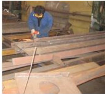
Resim 1.3: Spiral ile çapak alma
