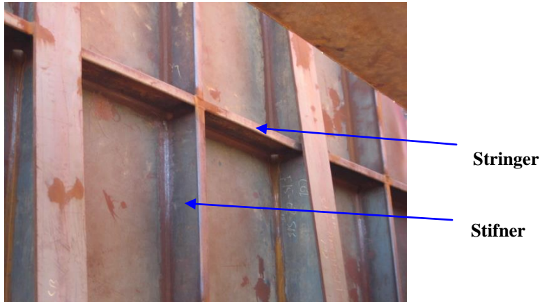
Resim 2.2: Hollanda profilinden yapılmış stringer ve stifner uygulaması
