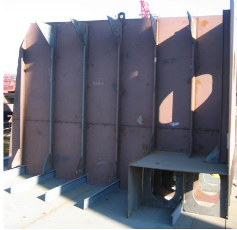
Resim 2.2: Perde stifner, braket ve tülani bağlantısı
