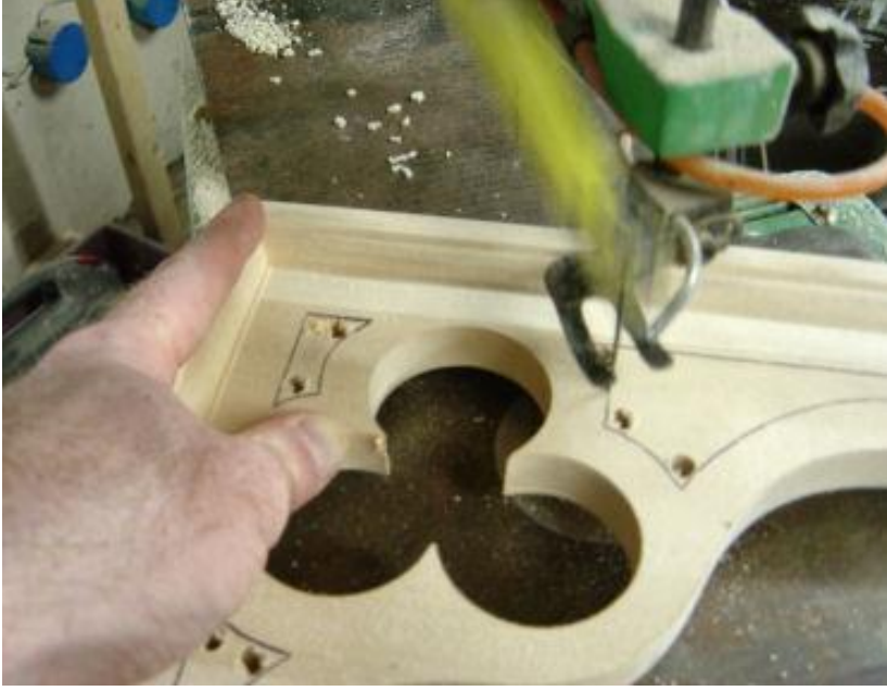
Fotoęraf 2.2: Dekupaj testere makinesinde ahşap model hazırlama
