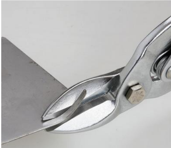
Fotoęraf 2.3: Sac kesme makası kullanarak metal model hazırlama
