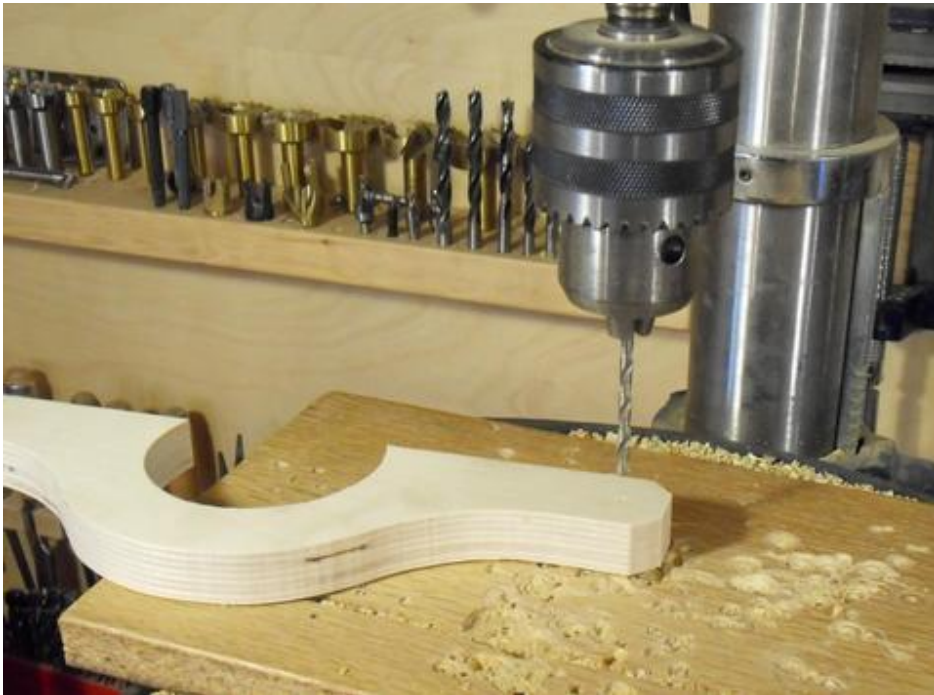
Fotoğraf 2.7: Modelin şablona uygun olarak delinmesi
